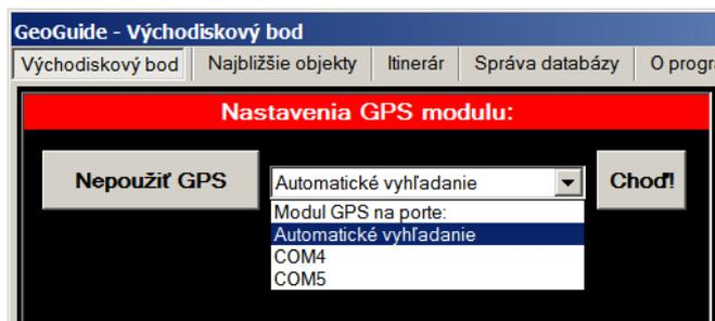
Ak poznáte parametre pripojenia, môžete ich zadať priamo sami, inak použite funkciu automatického vyhľadania GPS modulu. Pripojenie spustíte stlačením tlačidla **Chod!**, ak sa teraz rozhodnete pracovať bez GPS, stlačte **Nepoužiť GPS**. Po pripojení sa graficky zobrazuje stav prijímu signálu z jednotlivých družíc a celkový stav lokalizácie, tzv. GPS fix. Jednotlivé stavy a parametre sú výrazne farebne odlíšené, takže sa v paneli ľahko zorientuje aj laik:
