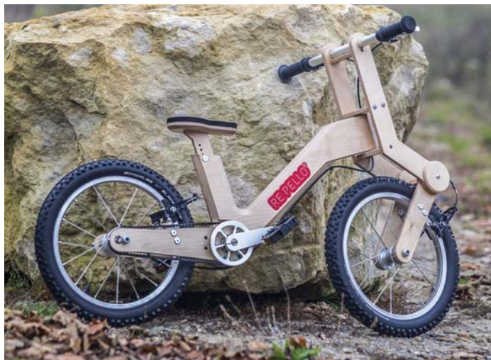
Celoodpružený bicykel pre deti model 16 vyrobený z brezovej preglejky
